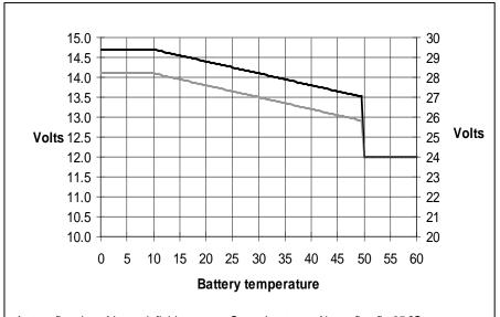
As tensões de saída predefinidas para a Carga Lenta e a Absorção são 25 °C. A tensão de Carga Lenta Reduzida sucede à tensão de Carga Lenta e a tensão de Absorção sucede à tensão de Absorção Aumentada.
