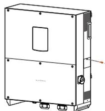
**Passo 6** Segure a ranhura (perto da tampa do ventilador) na parte de trás do inversor com os dedos e retire a ranhura do ventilador.
