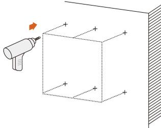
**Passo 5** Prenda firmemente a placa traseira à parede pelos conjuntos de parafusos de expansão fornecidos. O torque da porca de fixação é 35 N·m.
