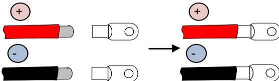
**Passo 4** Instale o tubo termocontrátil, encolha o tubo com o soprador de ar quente..
