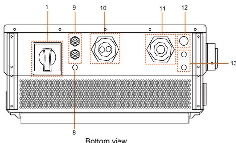
**Fig. 6-1** Área de conexão de cabos
