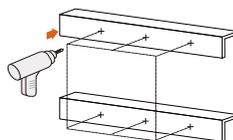
**Passo 5** Prenda firmemente a placa traseira à estrutura metálica pelo prendedor fornecido. O torque da porca de fixação é 35 N•m.
