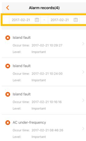
**Fig. 10-10** Registros de alarme de falha
