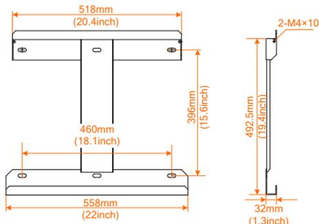
**Fig. 5-1** Dimensões da placa traseira (dimensões em mm)
