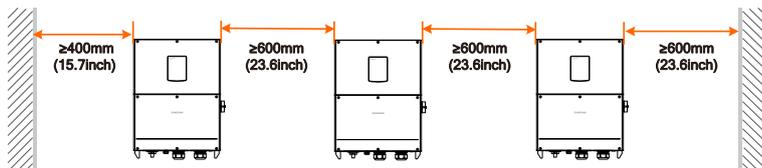
A instalação em pilha e a instalação triangular não são recomendadas.
