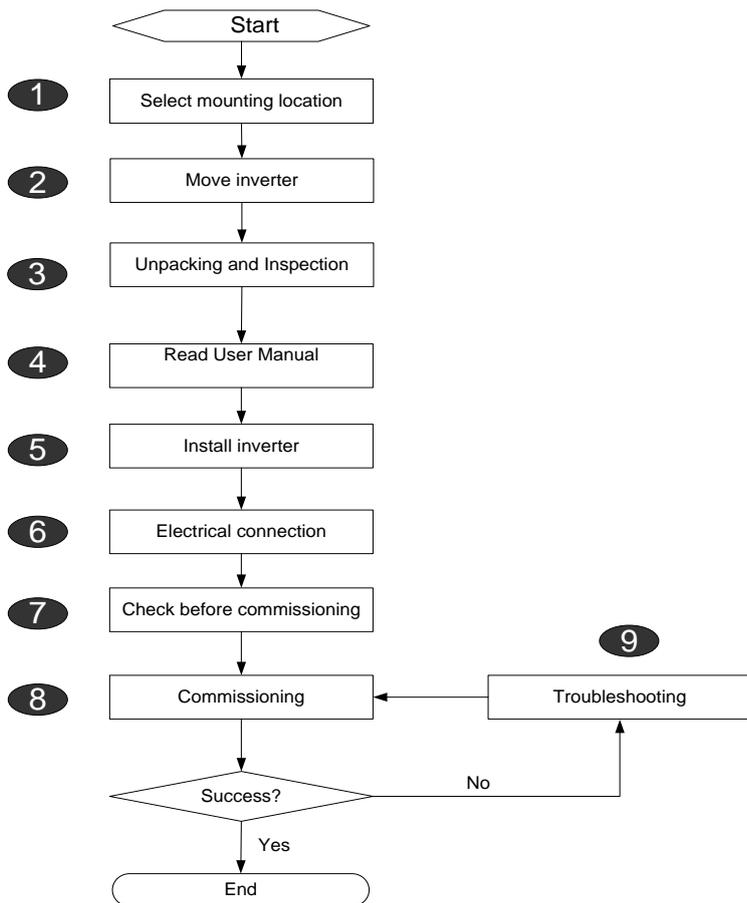
Fig. 3-1 Fluxo de instalação
