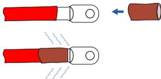
**Passo 5** Conecte a polaridade positiva e negativa do cabo CC aos terminais de conexão de cabo positivo e negativo correspondentes. A faixa de torque recomendada é 34-40 N·m.
