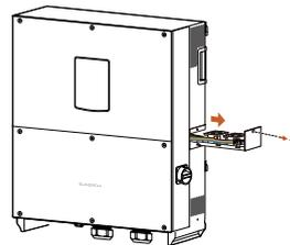
**Passo 7** Pressione a protuberância do gancho de trava e desconecte a junção de conexão do cabo para fora.
