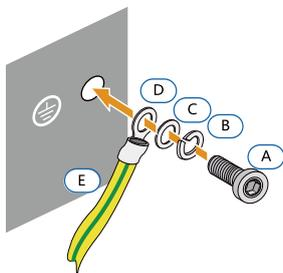
Fig. 6-5 Conexão do Segundo PE
