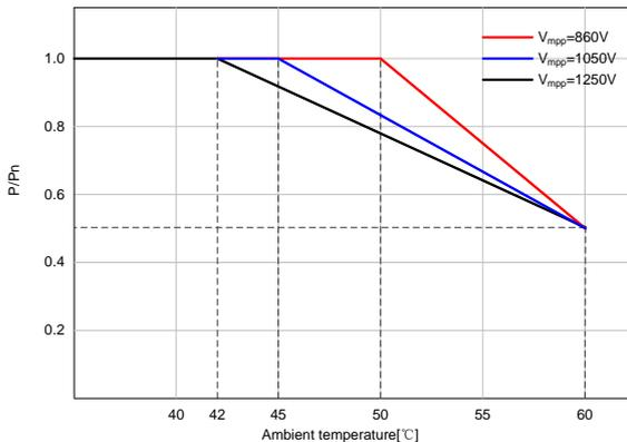
**Fig. 2-6** Desclassificação por sobretemperatura (FP=1)
