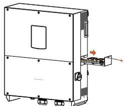
**Passo 8** Remover os ventiladores do inversor.
