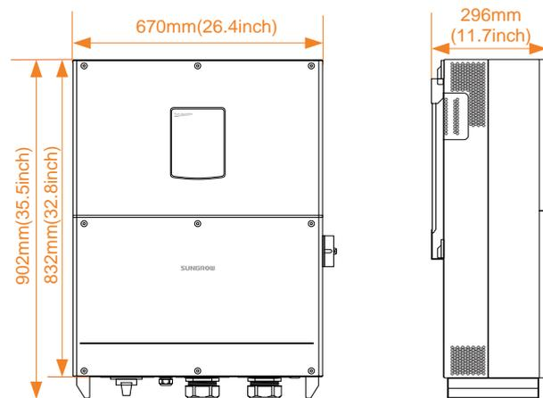
Fig. 2-3 Dimensões do inversor
