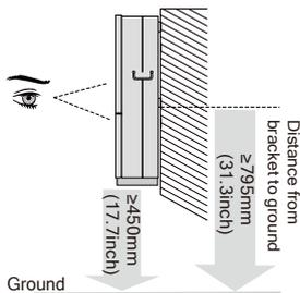
Instale o inversor verticalmente ou com uma inclinação traseira máxima de 75 graus. Não instale o inversor inclinado para a frente ou de cabeça para baixo.
